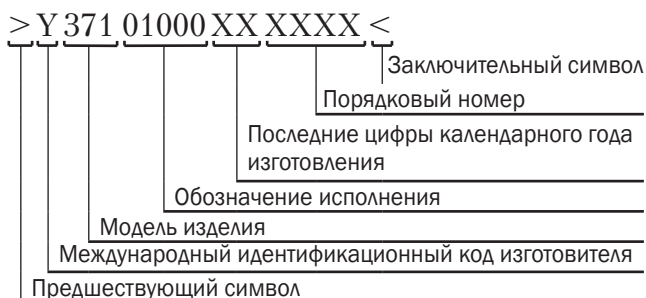
Рисунок 1.4 — Маркировочная табличка и ее расшифровка:
