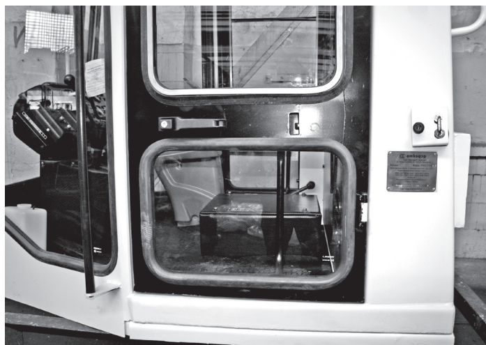
Рисунок 1.7 — Расположение маркировочной таблички кабины
