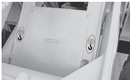
Рисунок 1.5 — Расположение знаков «Место строповки» на передней полураме
