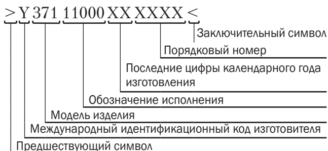
Рисунок 1.4 — Маркировочная табличка и ее расшифровка:
